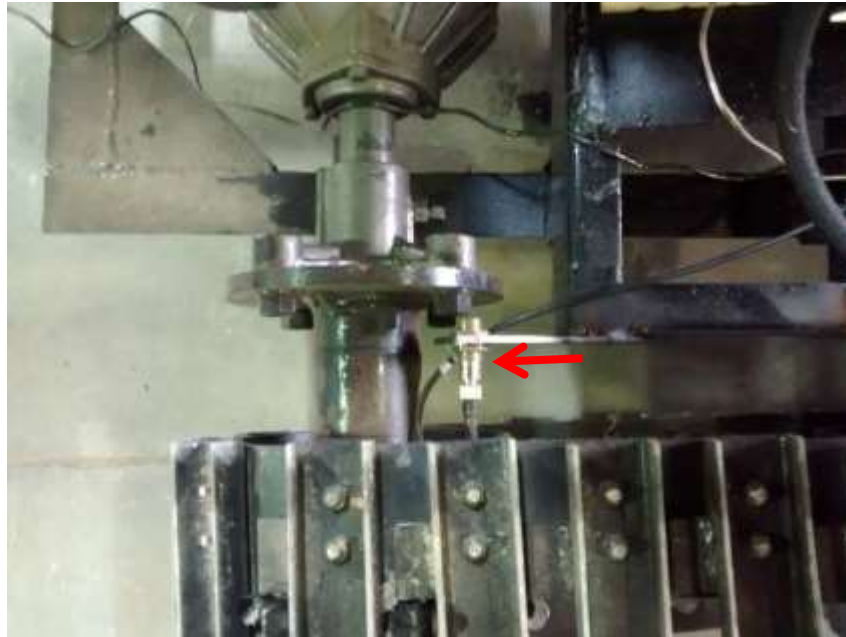
Figura 8. Sensor indutivo utilizado para a determinação da velocidade angular do eixo motriz da plataforma para locomoção de colhedora de café.
