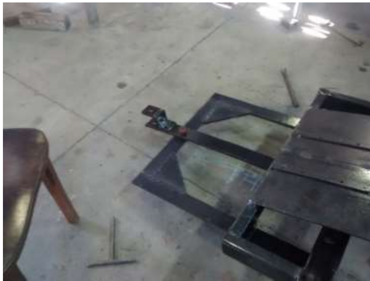
Figura 28. Montagem da barra de tração do protótipo.
