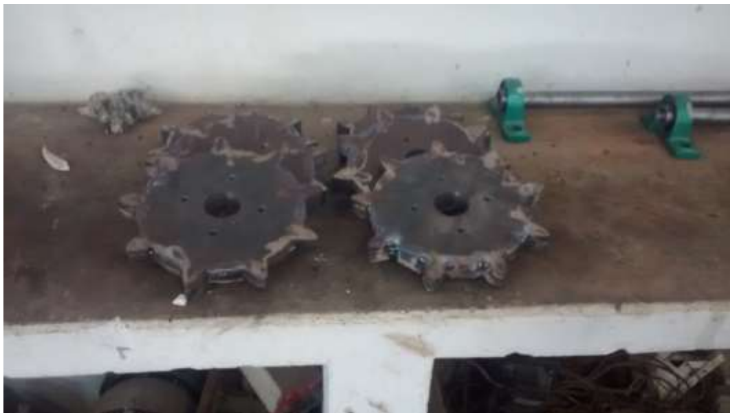
Figura 20. Conjuntos de rodas dentadas da plataforma para locomoção de colhedora de café.
