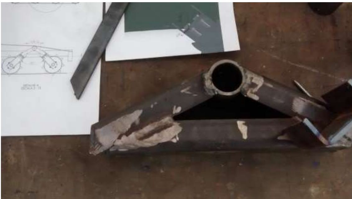
Figura 23. Processo de fabricação dos balanços.
