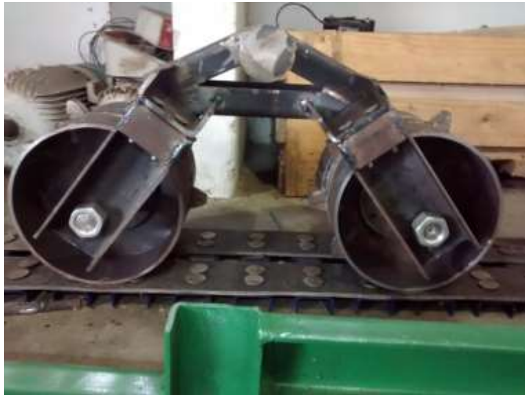
Figura 24. Montagem das rodas dentadas com os balanços internos.
