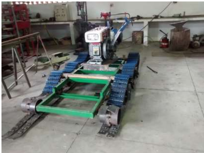
Figura 27. Montagem do conjunto motor transmissão ao chassi.
