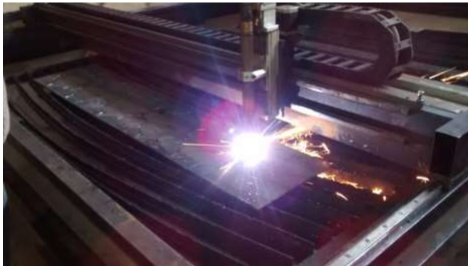
Figura 19. Cortes das rodas dentadas com o uso da máquina de corte a plasma.
