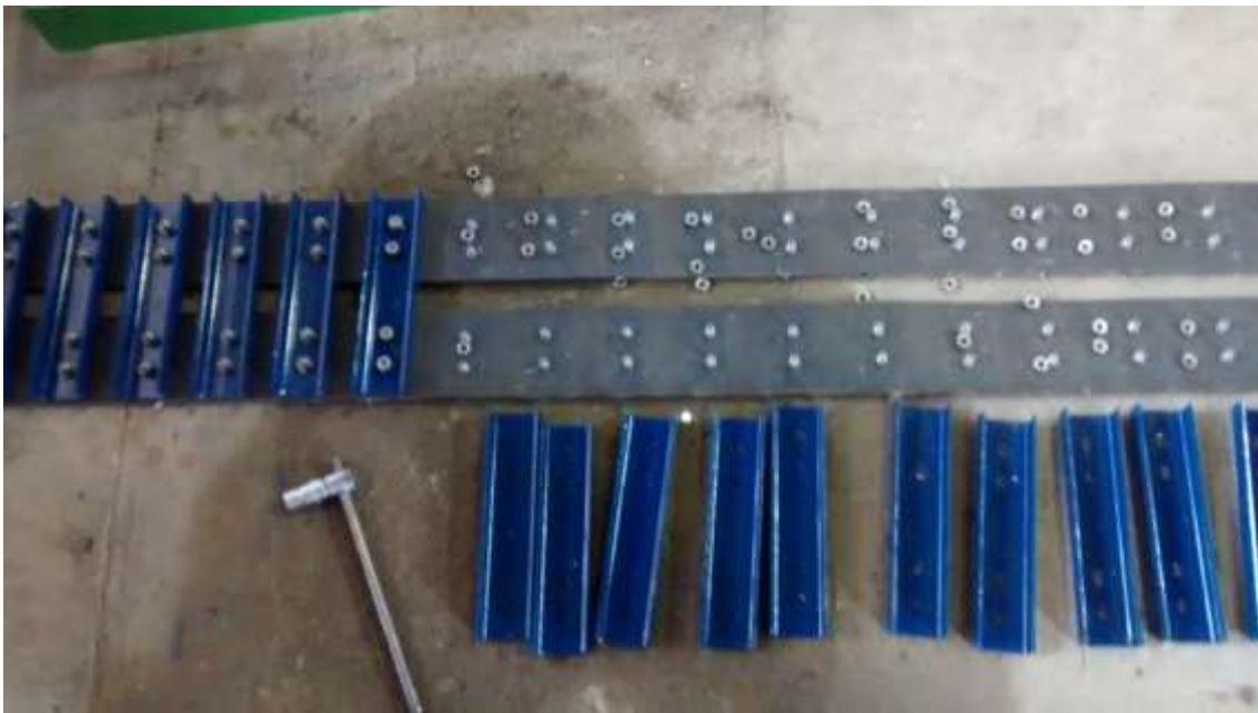
Figura 22. Construção da esteira do rodado.
