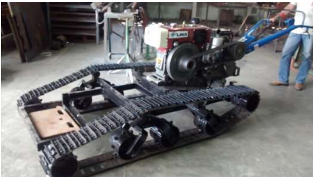
Figura 29. Protótipo da plataforma para locomoção de colhedora de café em regiões de montanha.
