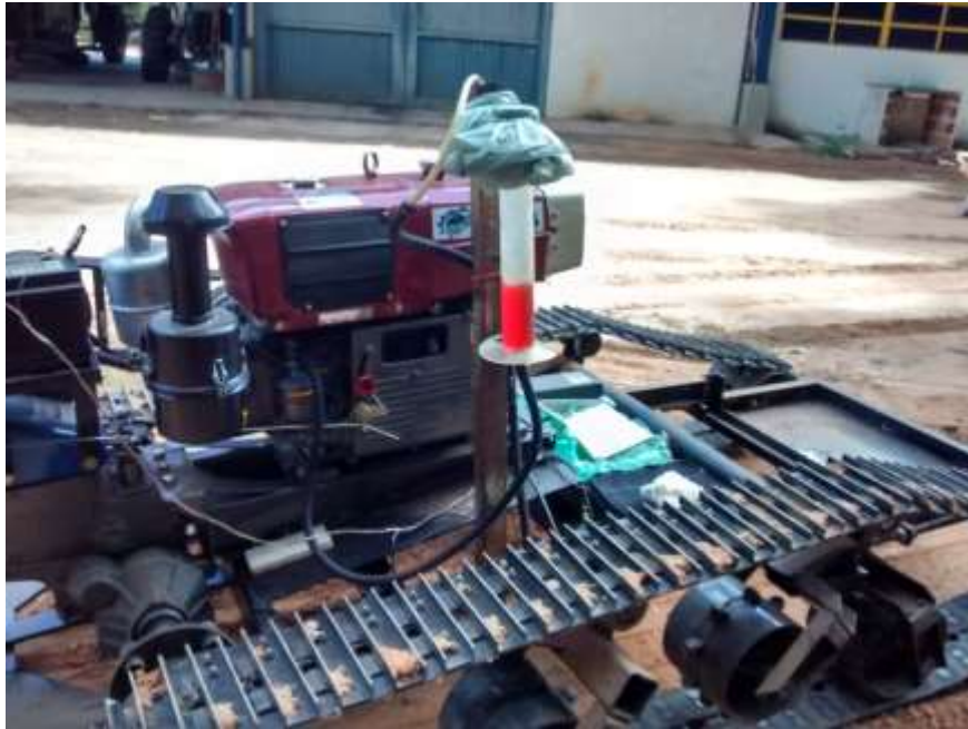
Figura 9. Determinação do consumo de combustível empregando uma proveta graduada instalada na linha de combustível do protótipo.
