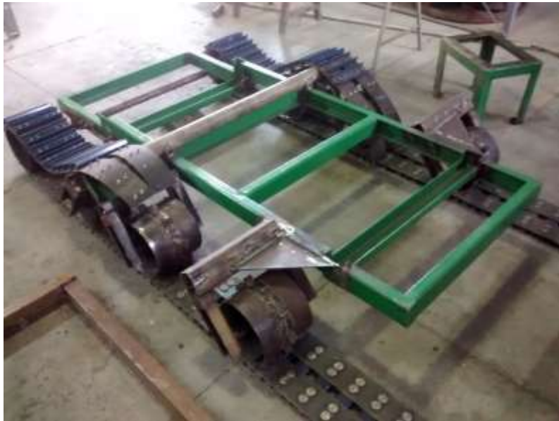
Figura 26. Montagem dos balanços ao chassi.
