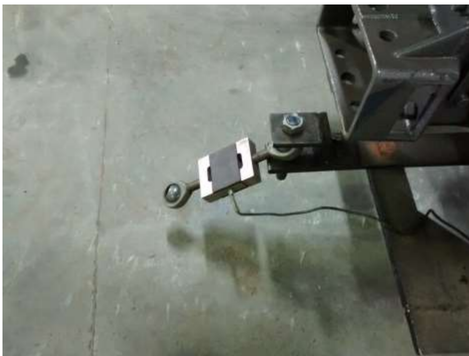
Figura 7. Célula de carga posicionada na barra de tração do protótipo.
