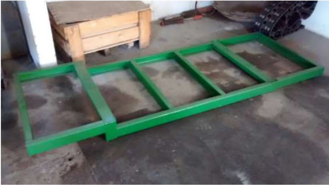
Figura 21. Chassi do protótipo da plataforma para locomoção de colhedora de café.
