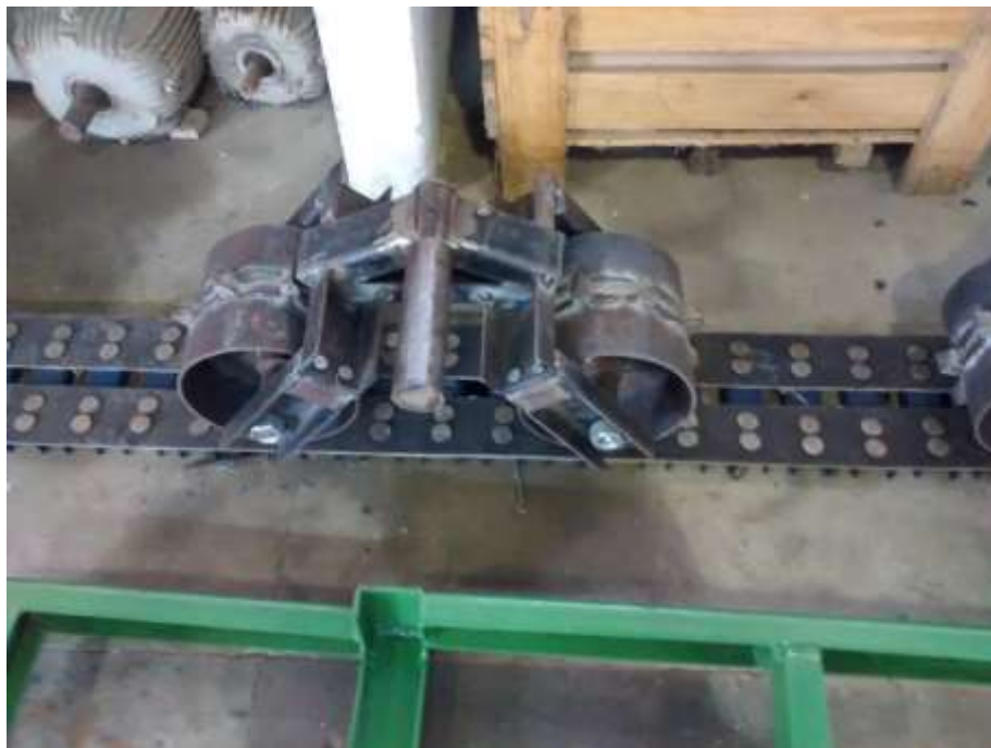
Figura 25 - Eixo de aço maciço que liga a montagem ao chassi.
