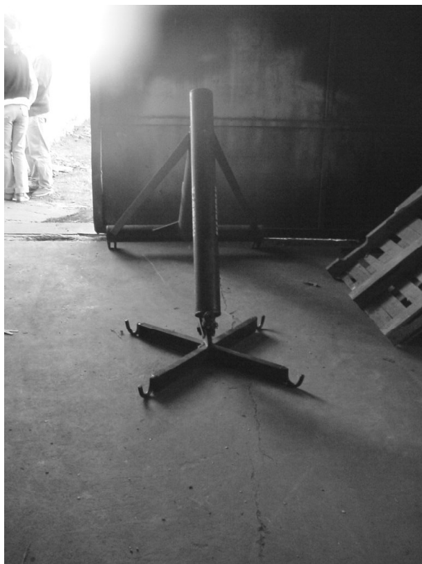
Figura 14 – Guindaste para erguer sacarias em local de trânsito de pessoas.
