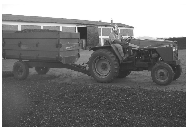
Figura 4 – Trator sem cabine de proteção e trabalhador sem EPIs.
