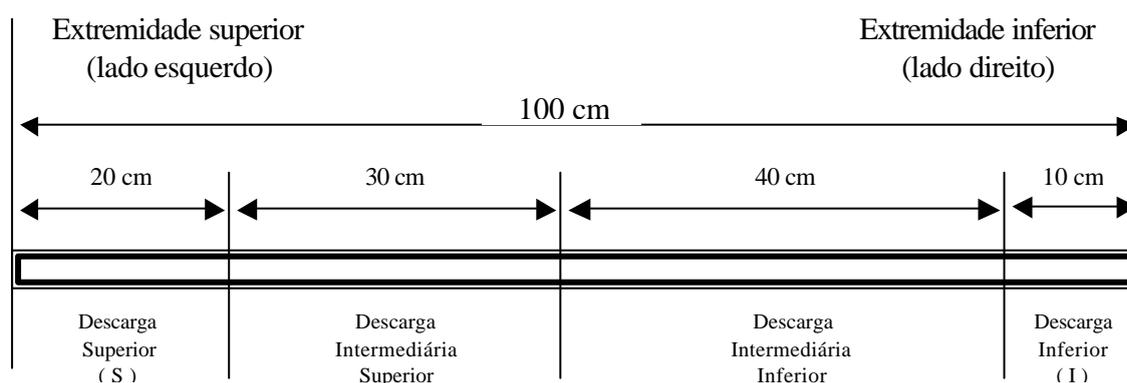
Figura 2. Esquema utilizado na divisão da região de descarga da mesa de gravidade para obtenção de diferentes tratamentos (vista frontal do equipamento).
