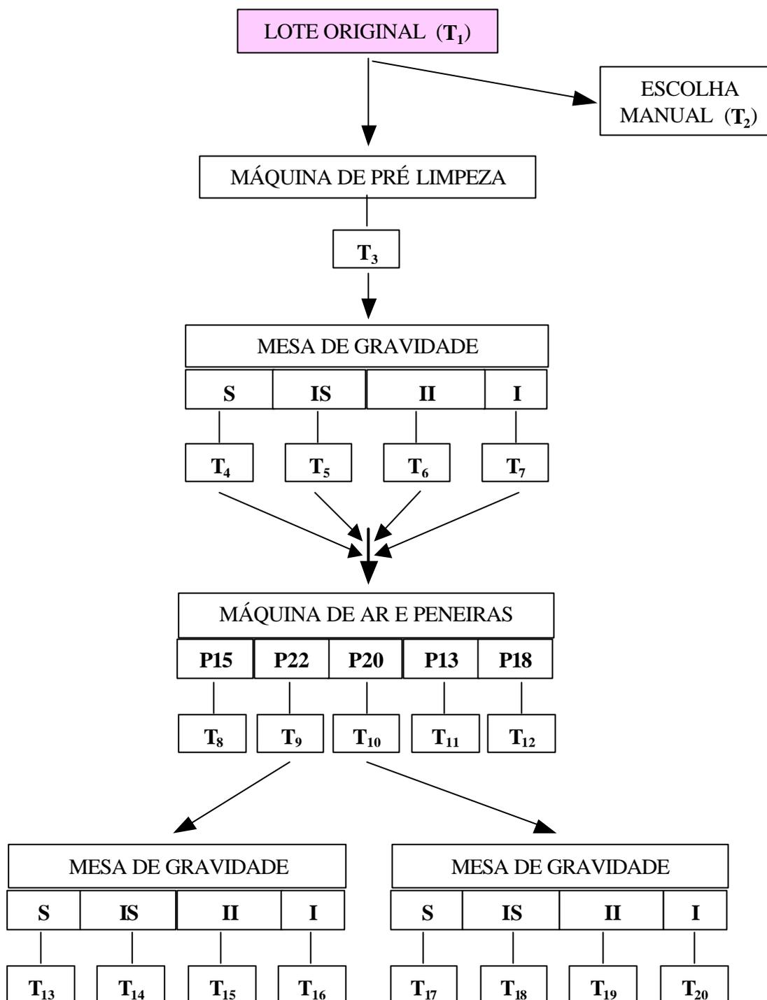
Figura 1. Esquema do fluxo operacional utilizado no beneficiamento das sementes e seqüência de obtenção dos diversos tratamentos ( $T_1$ ,  $T_2$ , ...,  $T_{20}$ ).
