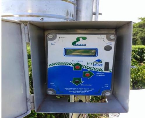
**Figura 7.** Vista frontal da estação meteorológica automática, modelo E500 (painel de controle e datalogger).
