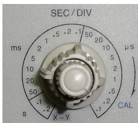
Figura 5.17 – Escala de tempo do osciloscópio analógico.
