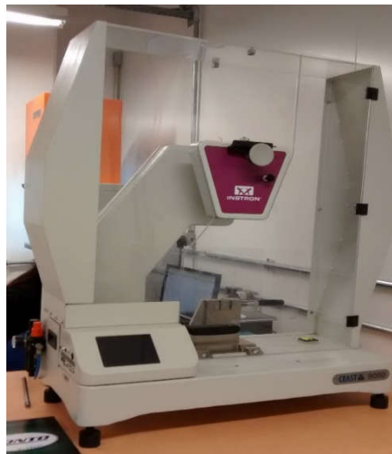
Figura 9 - Equipamento usado no ensaio de impacto
