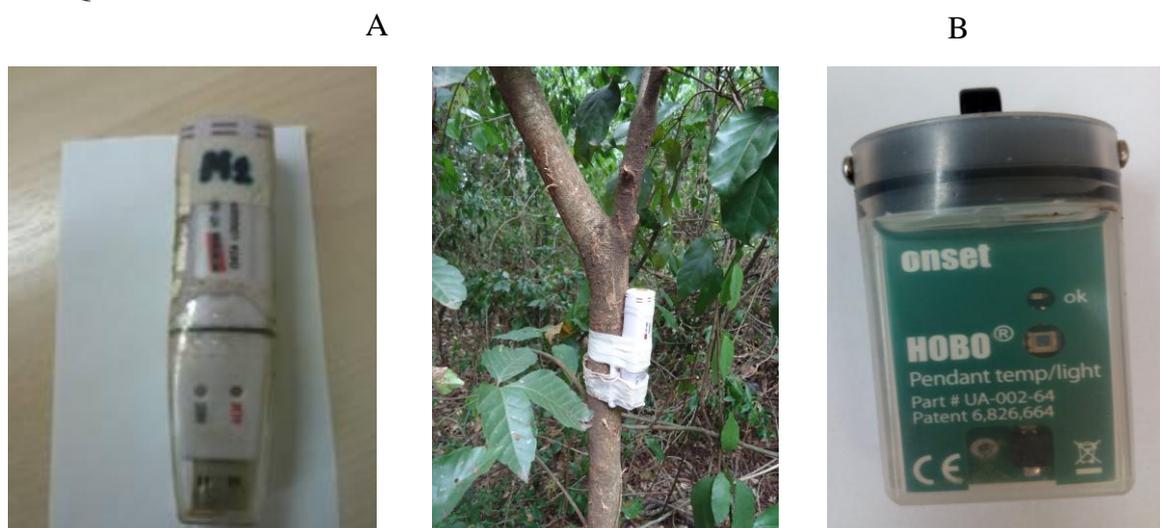
Figura 5 - Instrumentos para medição das variáveis microclimáticas. A) Sensor e datalogger de temperatura e umidade relativa do ar. B) Sensor e datalogger de radiação solar
