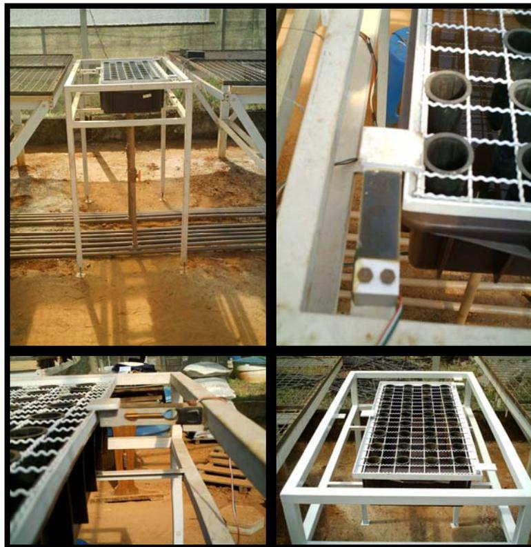
Figura 5 - Lisímetro de pesagem utilizando células de carga
