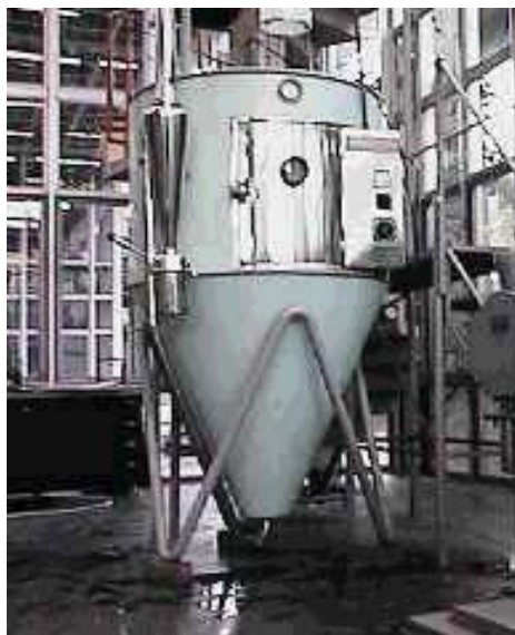
Figura 7 - Spray Dryer ANHYDRO: câmara cilíndrica de 1 m de diâmetro e 1 m de altura.
