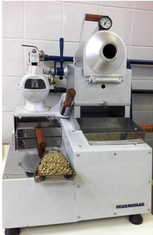
Antes de iniciar a torra, a temperatura é estabilizada em 200 °C; após atingir esta temperatura, colocam-se os grãos de café (250 g) para serem torrados até alcançar a cor desejada de acordo com os parâmetros do sistema de classificação de torra da Associação de Cafés Especiais de América, SCAA (2013), na qual, o número de cor Agtron deve estar entre 55 e 65, o que é equivalente à porcentagem de perda de peso entre 14 e 16% para café com umidade
