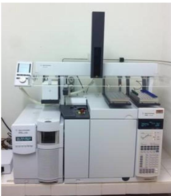
**Figura 6.2.** Cromatógrafo gasoso acoplado à espectrometria de massas Agilent Technologies modelo 5975C VLMSD.
