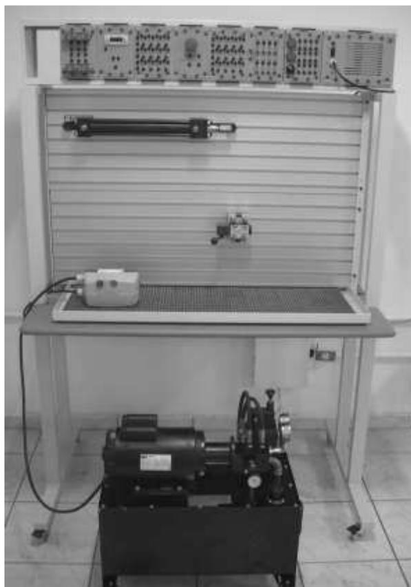
Figura 2: Bancada utilizada no experimento para o deslocamento do sistema fruto-pedúnculo-ramo em relação às hastes vibratórias.
