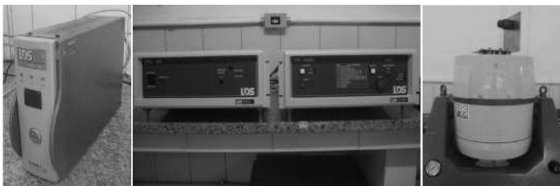
Figura 1: Da esquerda para direita: Gerador de sinais, fonte de alimentação, amplificador e vibrador eletromagnético.
